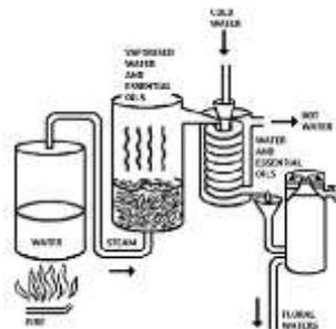
Gambar 1 Proses Penyulingan Minyak Nilam [1]
